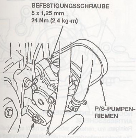
BEFESTIGUNGSMUTTER 8 x 1,25 mm 24 Nm (2,4 kg-m)
